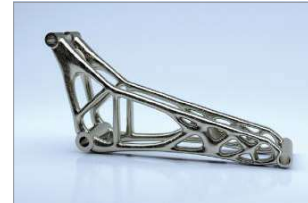
3D 프린터로 제작한, 자전거 로커 입에 대한 최적의 컨셉 설계물
